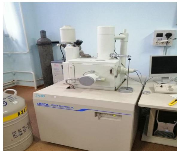
Рисунок 17 – Сканирующий электронный микроскоп Jeol **JSM - 6490 LA**
