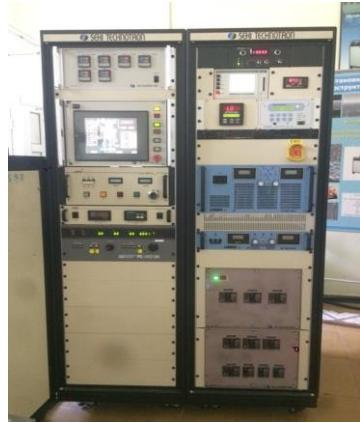
Рисунок 18 – Блок управления PECVD
