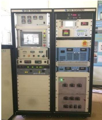
Рисунок 18 – Блок управления PECVD
